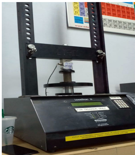
RAJAH 2. Mesin Load Trac II yang digunakan bagi menguji kekuatan mampatan tidak terkekang
